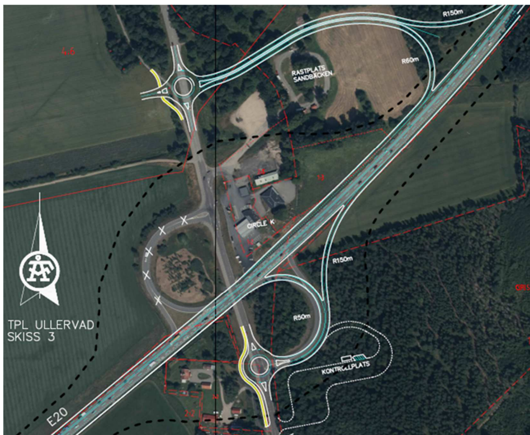
Figur 30. Ombyggnad av befintlig trafikplats Ullervad.
