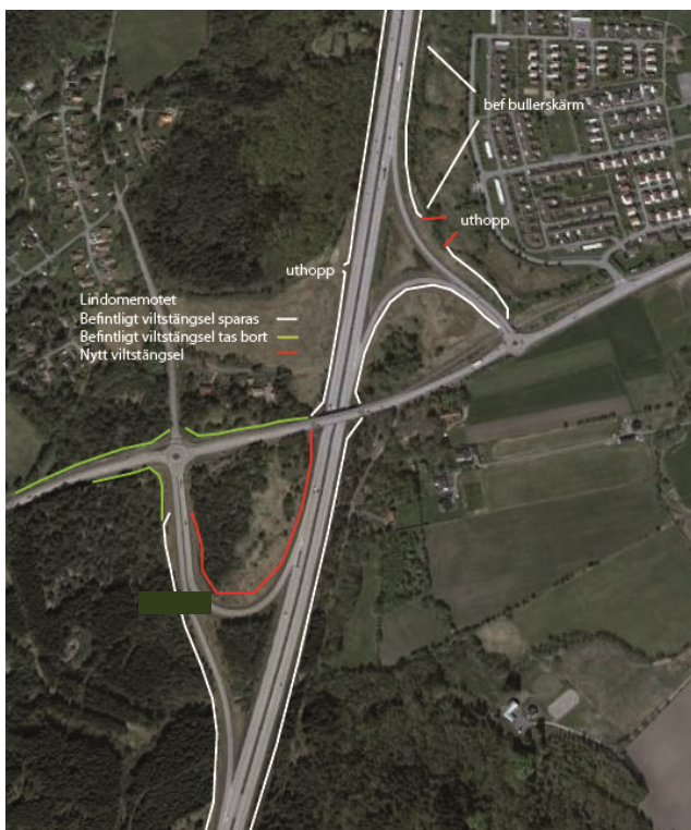
Figur 4.4.6 I Lindomemotet anpassas viltstängslet så att djuren leds mot bron över E6. Ytorna inne i trafikplatsen minskar.
