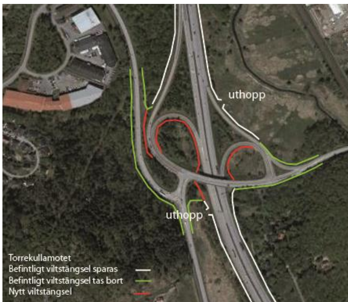
Figur 4.4.2 Torrekullamotet genomförs stora förändringar i viltstängslens dragning för att förbättra djurens möjligheter att gå över bron i trafikplatsen och för att skapa mindre ytor i trafikplatsen där djuren kan stå och beta.
