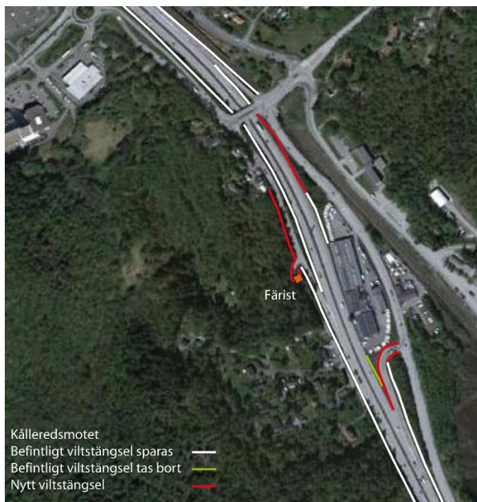
Figur 4.4.3 I Kålleredsmotet tätas påfartsvägar och en färist anläggs över Äpplekullevägen för att minska riskerna att djur rör sig ut på motorvägsområdet.
