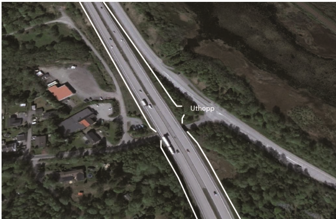
Figur 4.4.5 Söder om Kålleredsmotet finns lämplig plats för uthopp vid Sagsjön. Viltuthopp anläggs i bank på östra sidan E6 vid vägport för Sagsjön.
