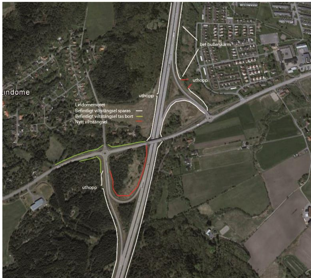
Figur 21. I Lindomemotet anpassas viltstängslet så att djuren leds mot bron över E6. Ytorna inne i trafikplatsen minskar.
