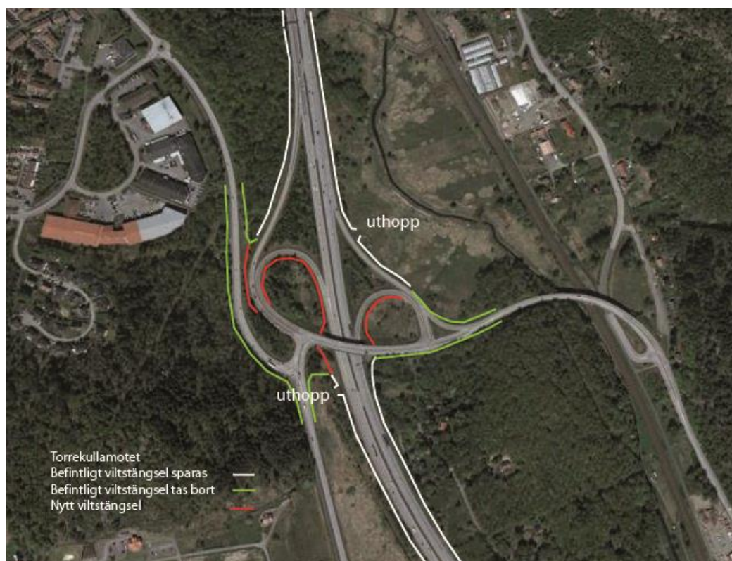
Figur 18. I Torrekullamotet genomförs stora förändringar i viltstängslens dragning för att förbättra djurens möjligheter att gå över bron i trafikplatsen och för att skapa mindre ytor i trafikplatsen där djuren kan stå och beta. Figuren visar fyra möjliga platser för uthopp, men förslagsvis anläggs endast tre av dessa uthopp.
