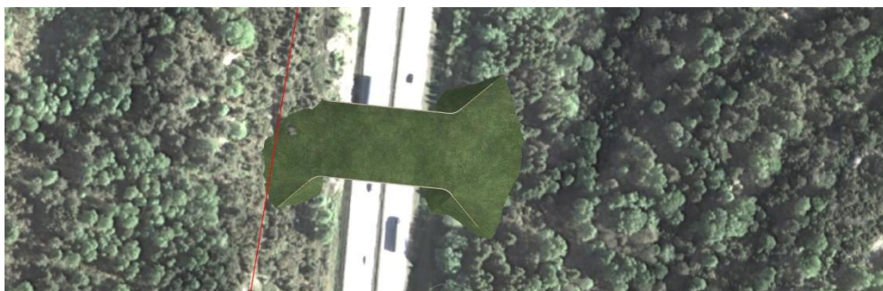
Figur 7. Ekoduktläget med förslag till terränganpassningar med lutning 1:6. N-2000 gräns i rött.
