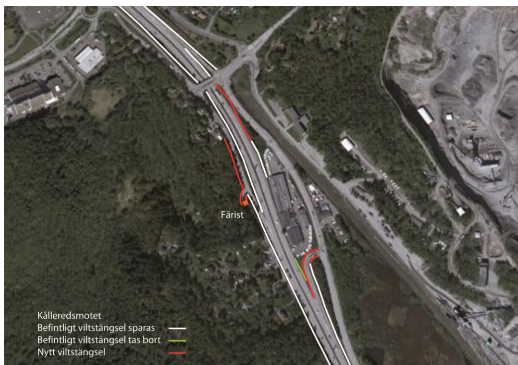
Figur 19. I Kålleredsmotet tätas påfartsvägar och en färist anläggs över Äpplekullavägen för att minska riskerna att djur rör sig ut på motorvägsområdet.
