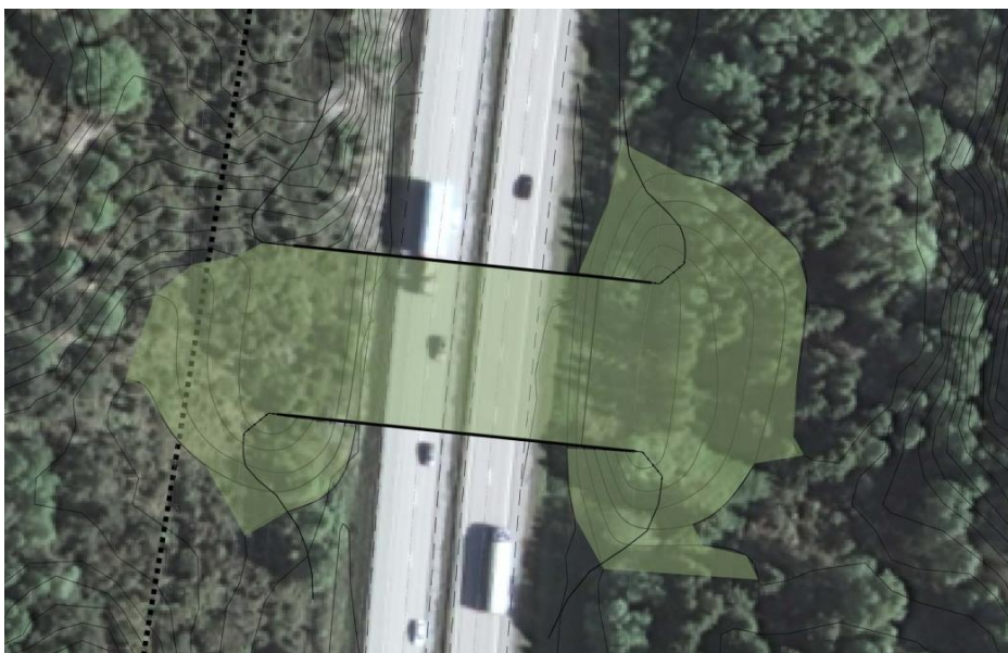
Figur 7.4.1 Modellering av slänter samt anslutning av faunastängsel mot faunaskärm över ekodukten.
