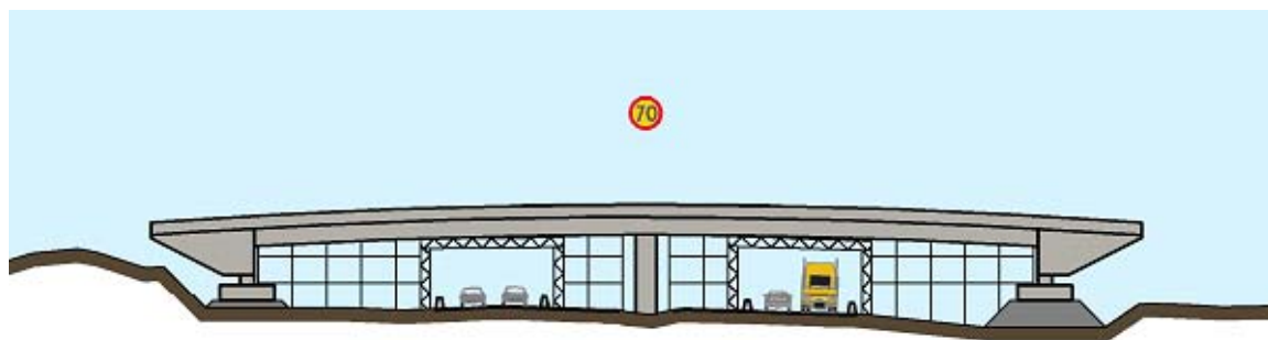
Figur 26. Byggande av ekodukt med portal för trafik
