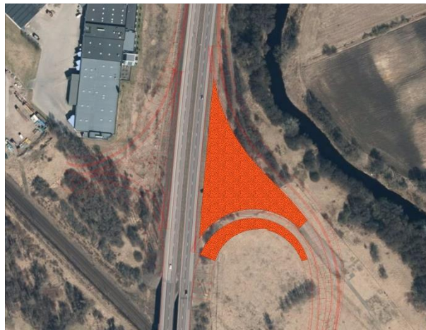
Figur 22 Översikt över den yta (orangetonad) inom vilken sand ska läggas ut överst på slänterna till de nya ramperna till trafikplats 42.
