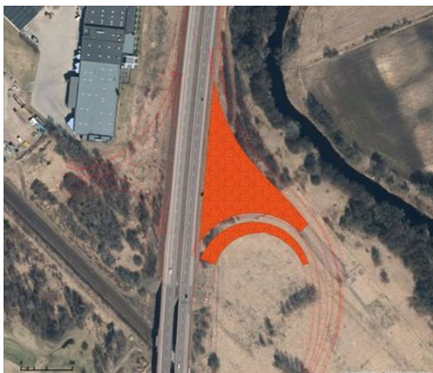
Figur 19. Översikt över den yta (orangetonad) inom vilken sand ska läggas ut överst på slänterna till de nya ramperna till trafikplats 42.
