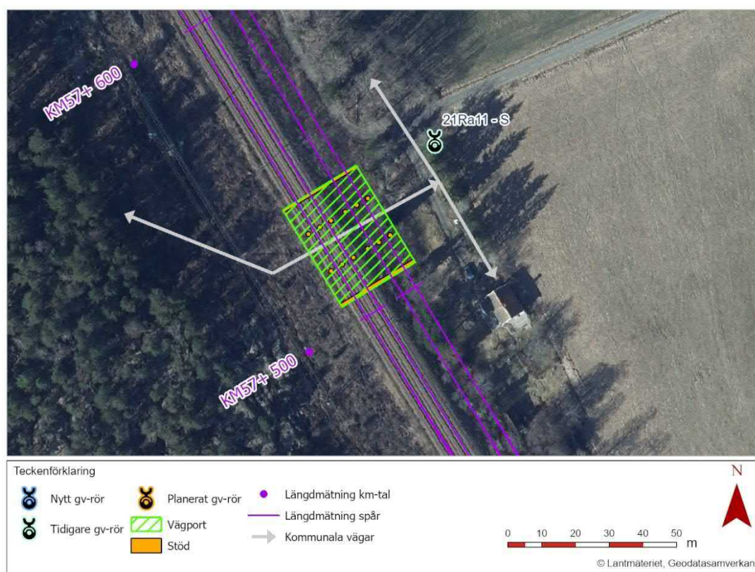
Figur 35. Planerad brokonstruktion för vägporten (Södra passagen) i planvy. Uppsala kommun planerar en ny vägförbindelse under järnvägen.
