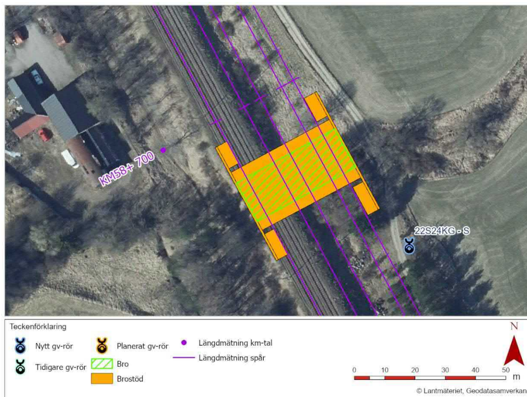
Figur 33. Planerad brokonstruktion vid viltpassagen i planvy.
