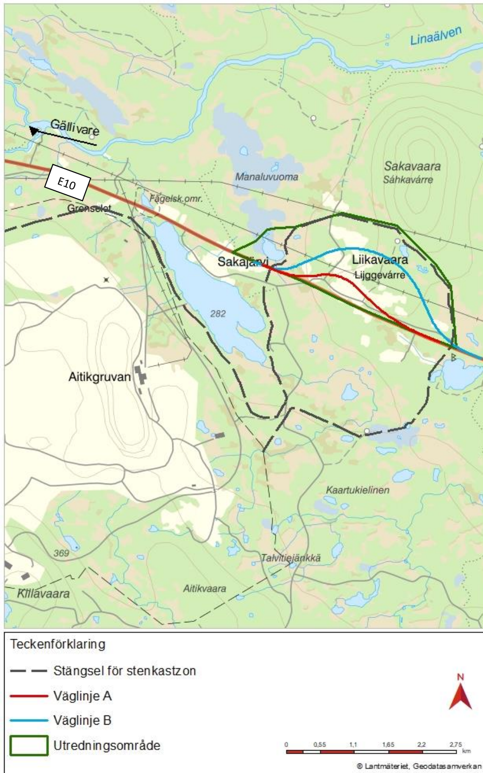
Figur 2: Utredningsområde med preliminära linjeval för omdragning av del av E10. I figuren syns även stängsel för planerad gruva.
