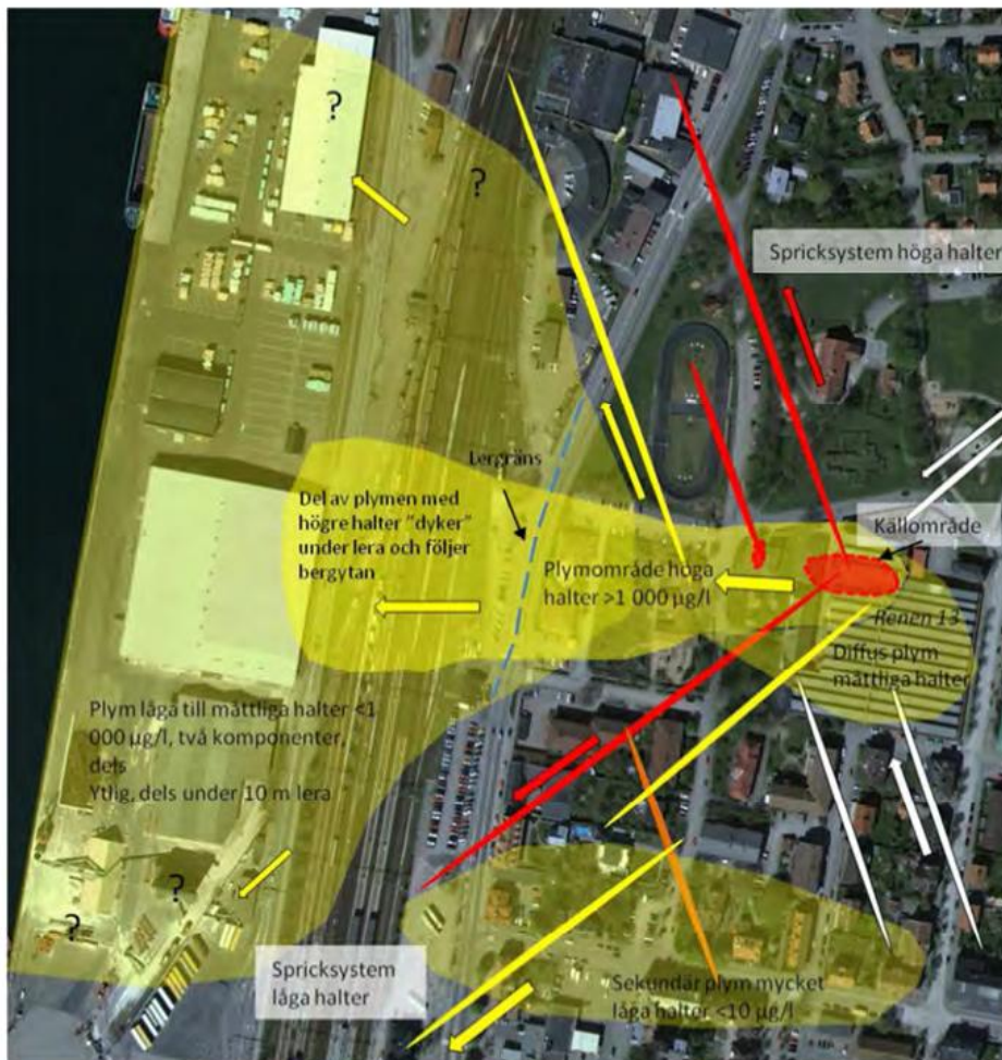
Figur 4-16. Tidigare tolkning av föroreningsutbredning i plan i närområdet kring kvarteret Renen (Structor, 2011).
