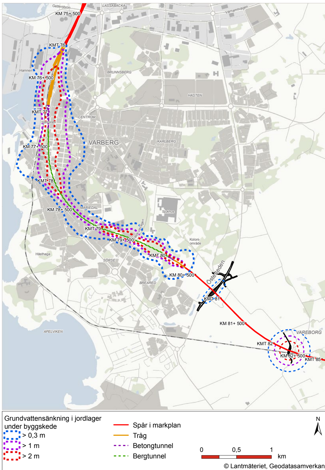
Figur 3.1 Beräknad grundvattensänkning i jordlagren under byggskedet.
