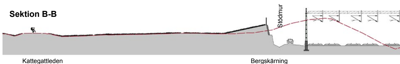
Figur 11.6 Sektion som visar bergskärning med stödmur, vilka tillsammans utgör bullerskydd mot Natura 2000-området.
