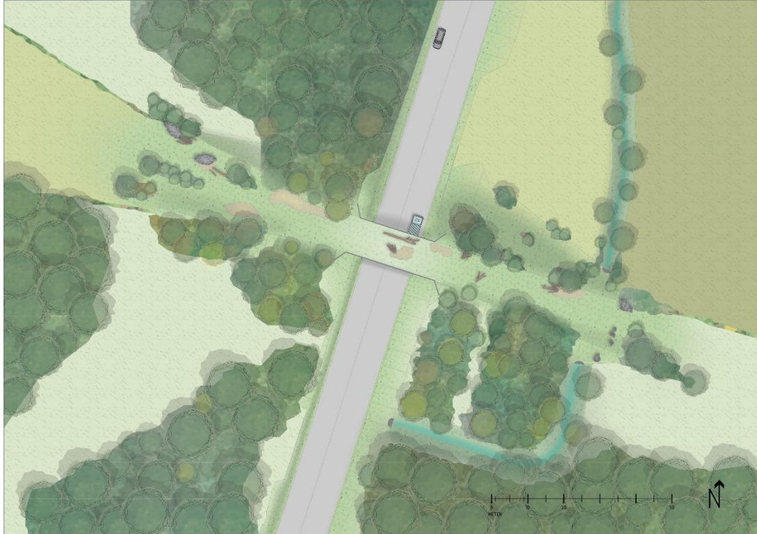
Figur 27. Exempel på utförande av faunapassage.
