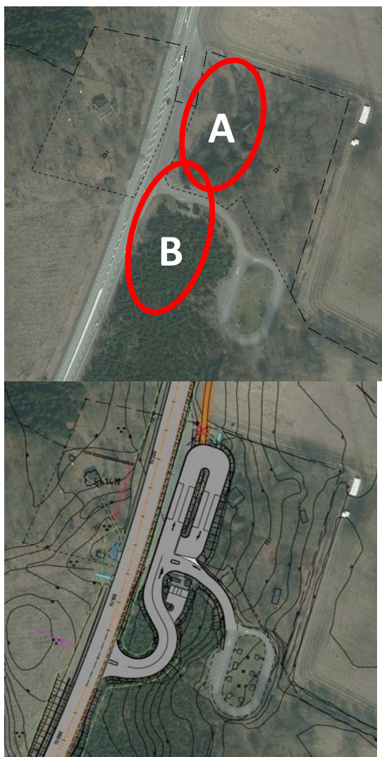
Figur 17. Analyserade alternativ, A och B, för rastplats Norra Mellby till vänster samt föreslagen utformning till höger.
