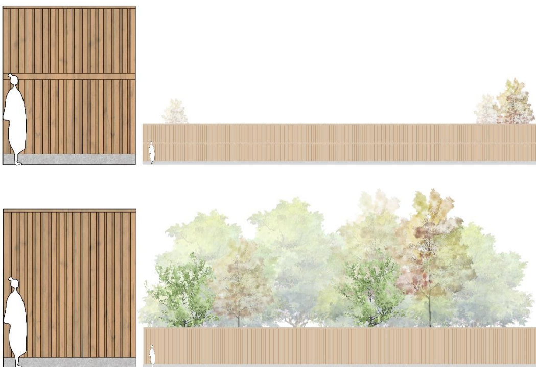
Figur 19. Föreslagen utformning av vägnära bullerskyddsskärm i landskapet.
