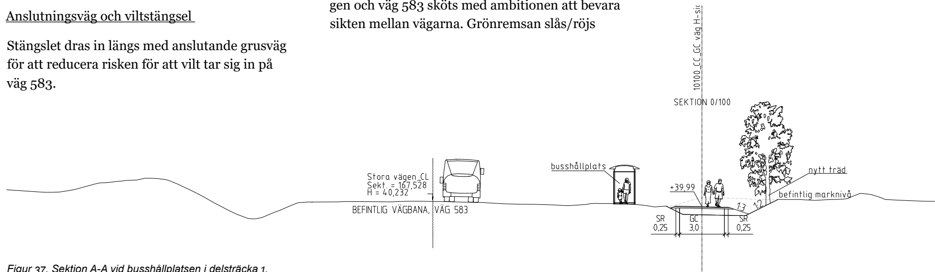
Figur 37. Sektion A-A vid busshållplatsen i delsträcka 1.
