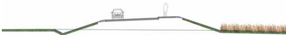
Gatusektion 1:300 C-C: Befintlig åker möter gräsbeklädd slänt. Området mellan väg och industriområde blir gräsyta. Tunn grön linje illustrerar befintlig mark.
