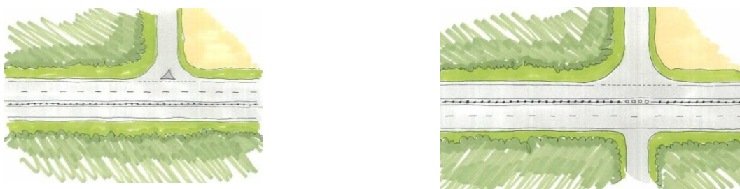
Bild: Exempel på "Höger in-Höger ut"-lösning (t v) och traktoröverfart (t h).
