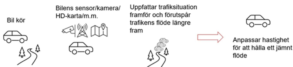
Figur 16. Principfigur som beskriver hur PCC fungerar
