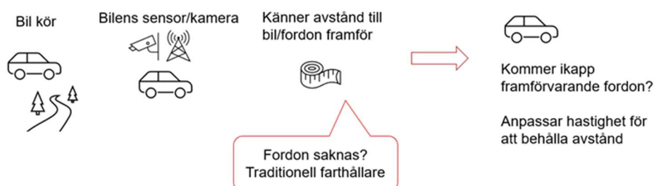
Figur 15. Principfigur som beskriver hur ACC fungerar
