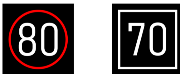
Figur 5. Till vänster visas variabel föreskriven hastighet och till höger rekommenderad högsta hastighet
