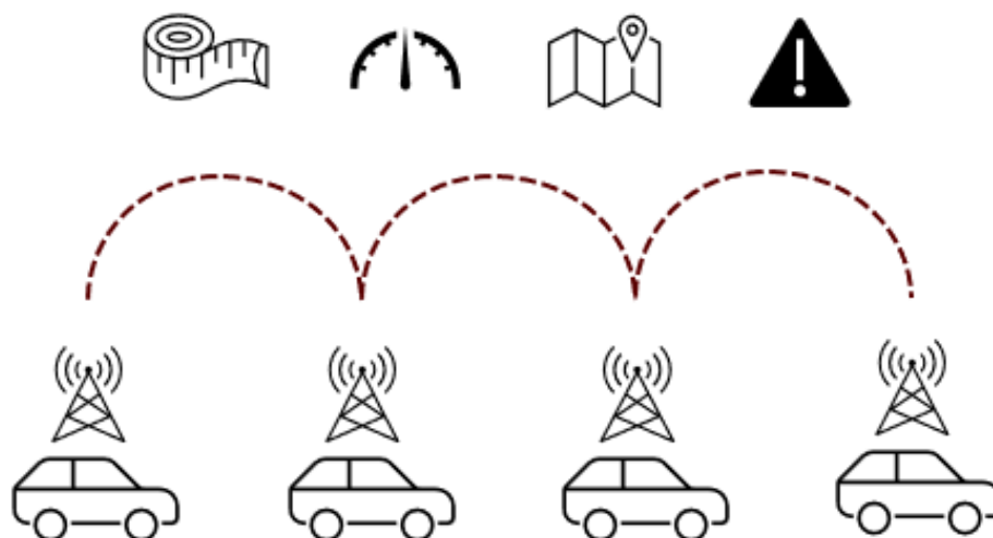
Figur 20. Principfigur som beskriver hur V2V fungerar
