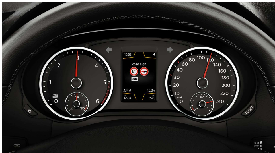
Figur 6. Vägskiltsavläsare i ett fordons instrumentpanel (Seat, 2024)
