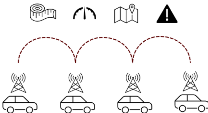
Figur 11. Principfigur som beskriver hur V2V fungerar
