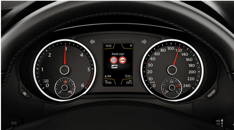
Figur 6. Vägs skyltsavläsare i ett fordons instrumentpanel (Seat, 2024)
