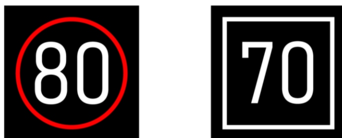
Figur 4. Två olika variabla hastigheter. Till vänster visas variabel föreskriven hastighet och till höger syns rekommenderad högsta hastighet
