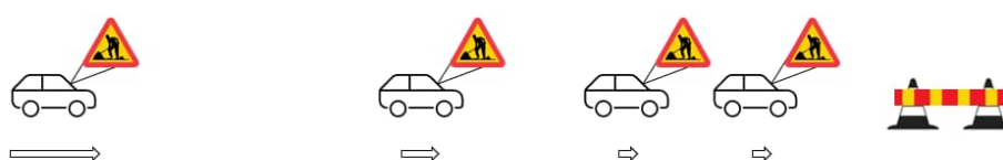
Figur 6. Principskiss som beskriver hur den digitala tjänsten riktade till uppkopplade fordon Varning för vägarbete (RWW) verkar för att förhindra en upphinnandeolycka i ett köslut vid ett vägarbete
