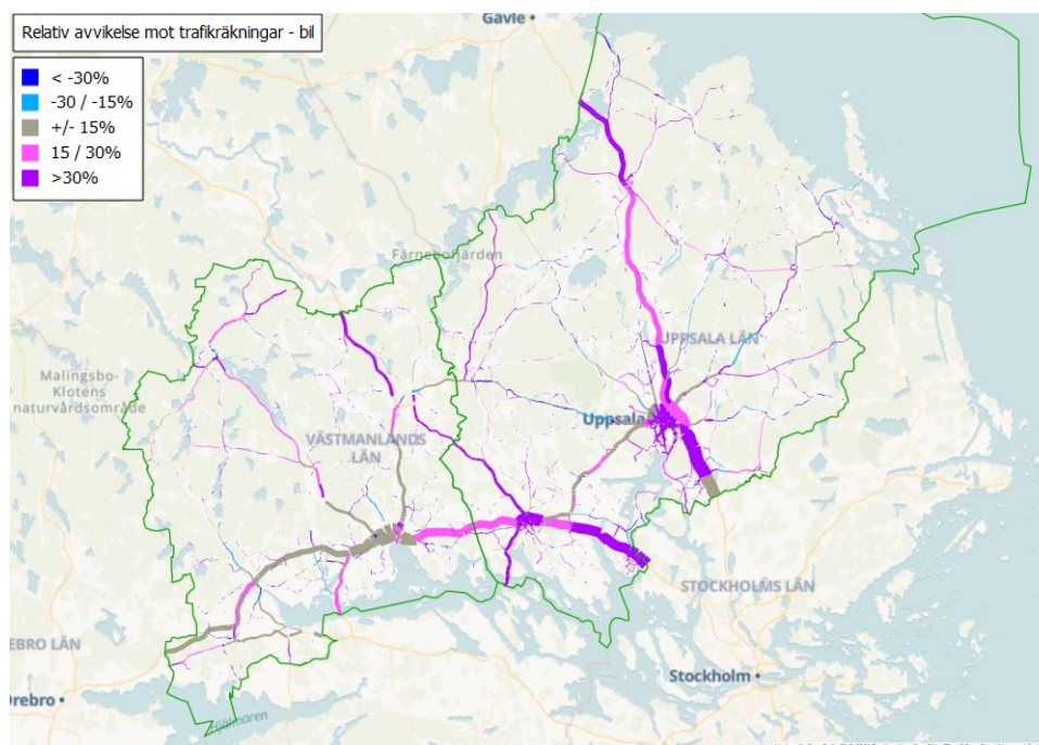
Figur 118 Relativ avvikelse mot trafikräkningar (personbil pb+pby) i Västmanlands län och Uppsala län.
