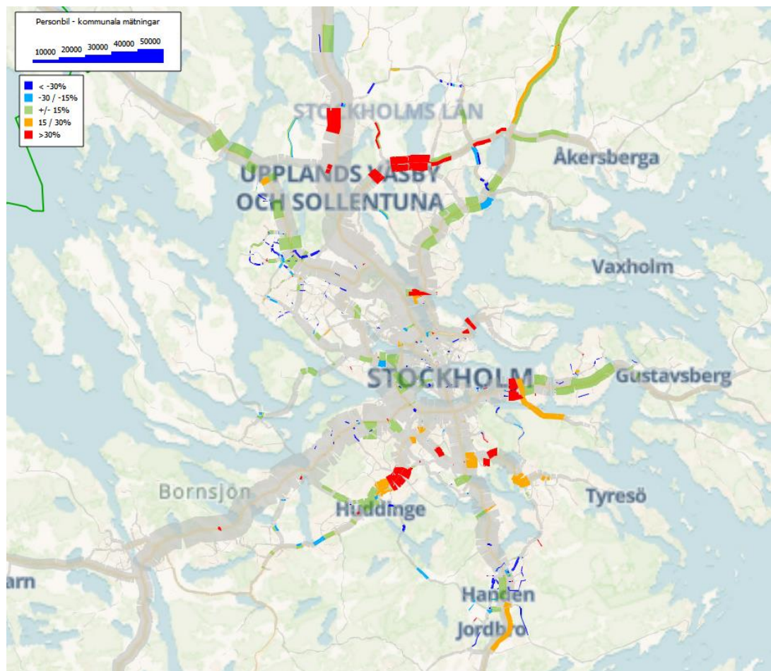
Figur 50- Jämförelse mellan modellgenererade flöden och trafikräkningar för vardagsdygn
