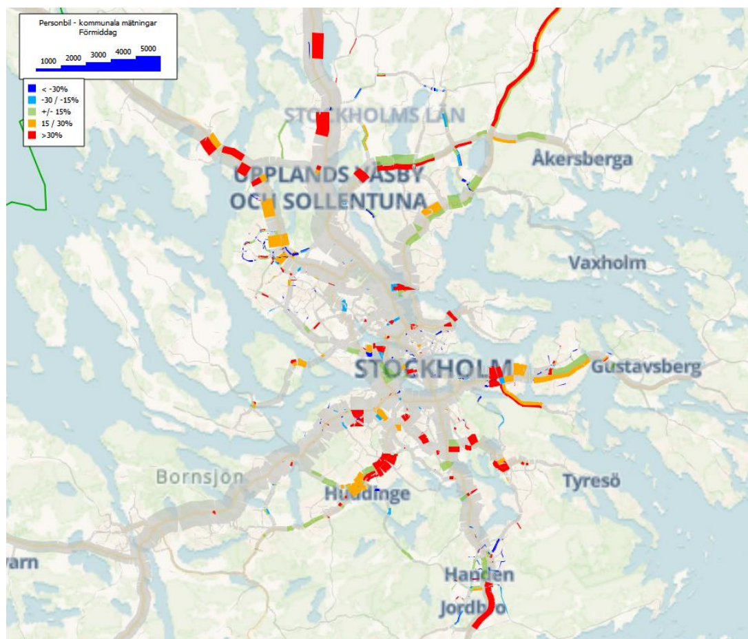
Figur 52-Jämförelse mellan modellgenererade flöden och trafikräkningar för förmiddag
