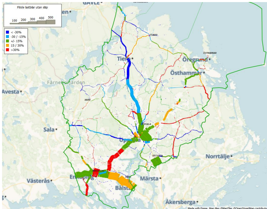
Figur 39: Relativ avvikelse mellan modellerad och uppmätt lastbilstrafik utan släp i Uppsala län
