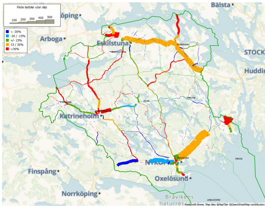
Figur 42: Relativ avvikelse mellan modellerad och uppmätt lastbilstrafik utan släp i Södermanlands län
