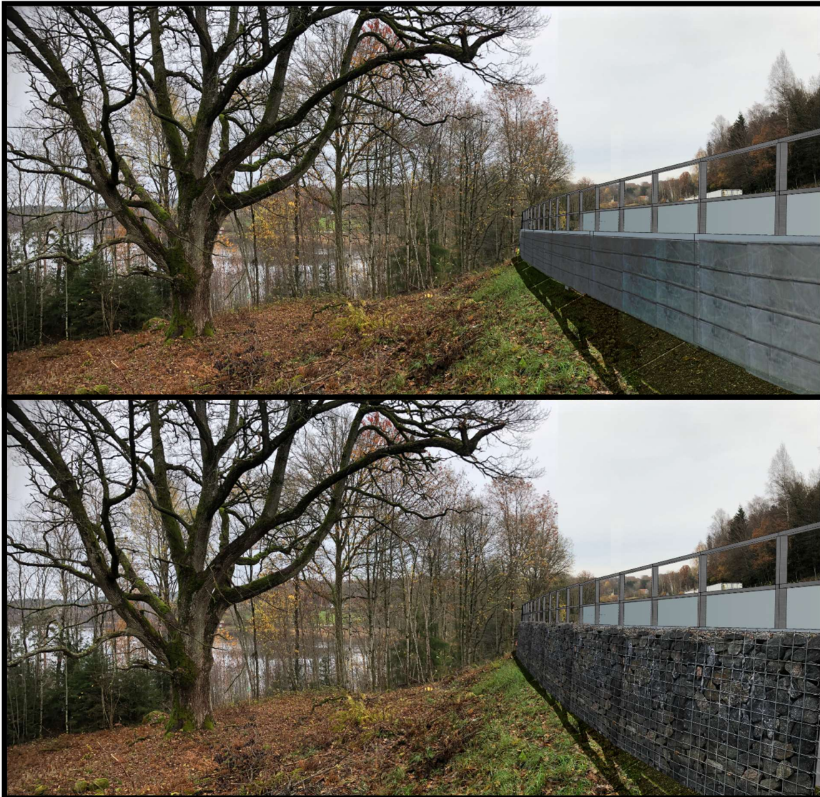
Figur 34. För att minska markintrånget kompletteras slänterna med en 1–3 meter hög stödmur. I övre bild illustreras en stödmur i gjuten betong. I nedre bild illustreras en stödmur med stenmaterial. Naturmarken är svårtillgänglig och slyartad men det finns även naturvärden med stora karakteristiska ekar. Fotocollage: Mika Määtä, AFRY
