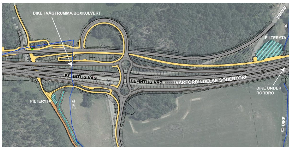
Figur 5 Översikt av filterytor och genomledning av diken under Tvärförbindelse Södertörn
