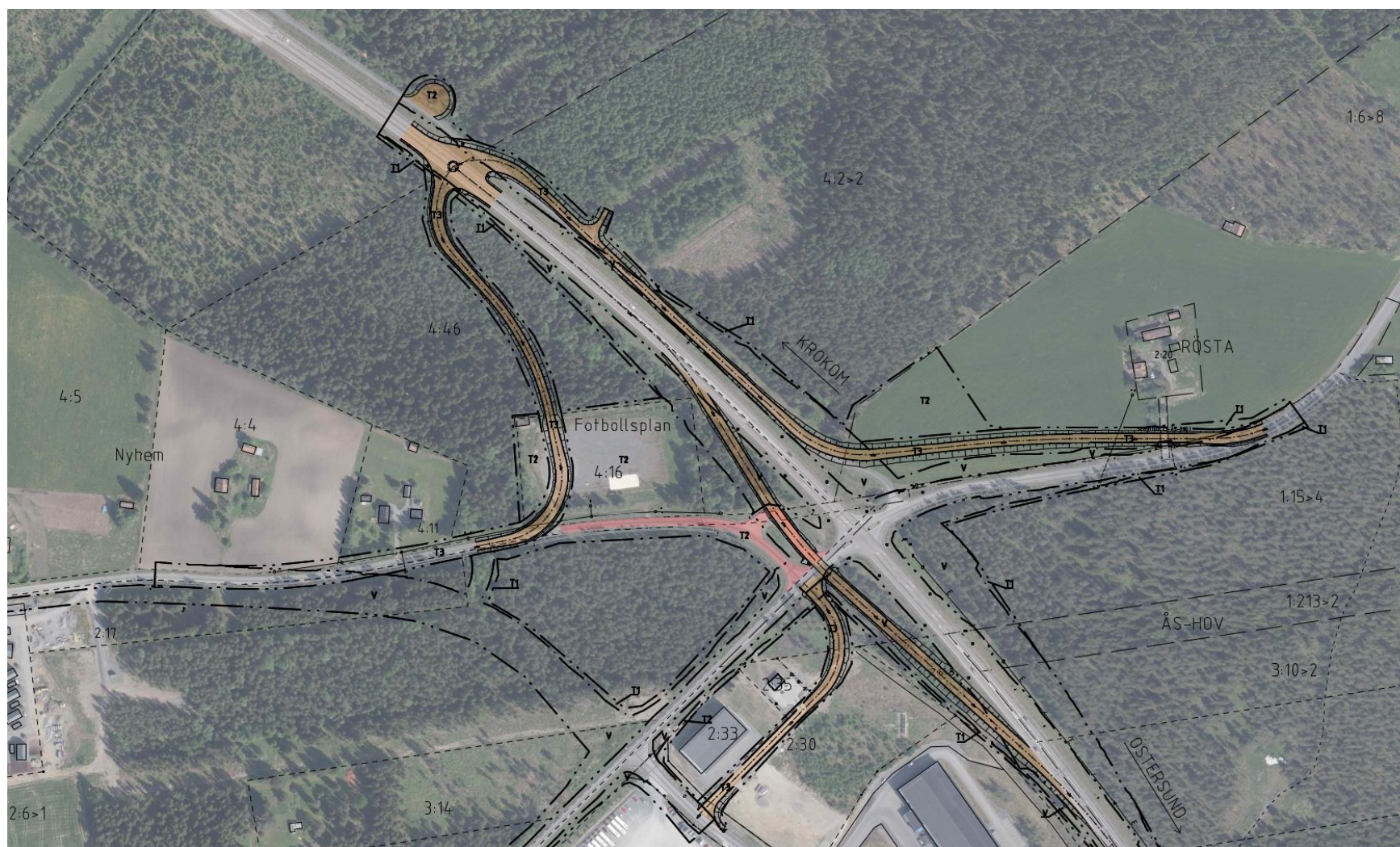
Figur 8 – Omledningvägar under byggskedet.
