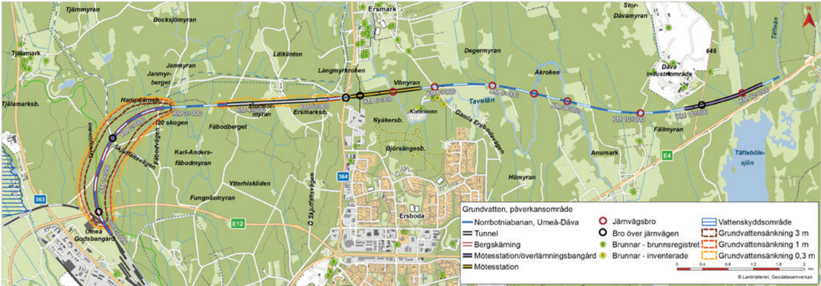
Figur 6.14-1 Grundvattenförutsättningar med beräknad grundvattensänkning.
