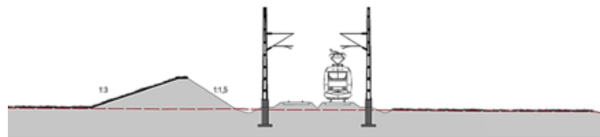
Figur 4.12 Alternativ med brant lutning av grovt krossmaterial 1:1,5 kräver högre vallhöjd för att dämpa buller.
