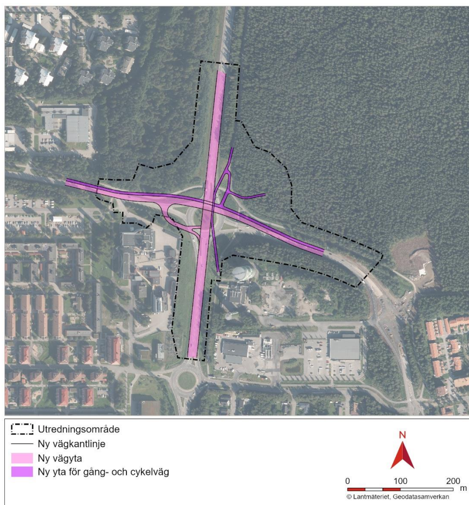
Figur 20. Skiss 2 över möjlig placering och utbredning av planskild korsning för trafik längs E4 över Tomtebovägen.
