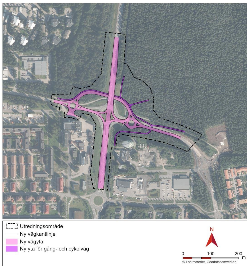
Figur 19. Skiss 1 över möjlig placering och utbredning av planskild korsning för trafik längs E4 över Tomtebovägen.
