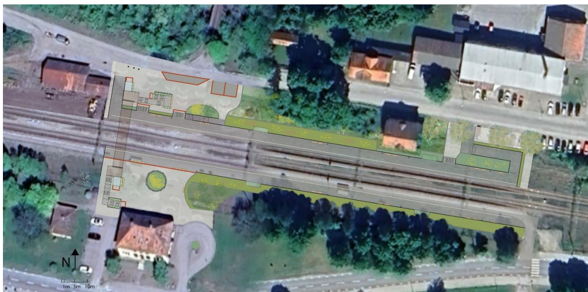
Figur 25. Placering av nytt spår, ny plattform, ny passage med tillhörande trappor, hissar och planteringar monterat på flygfoto för att visa förhållandet till befintlig situation på platsen.
