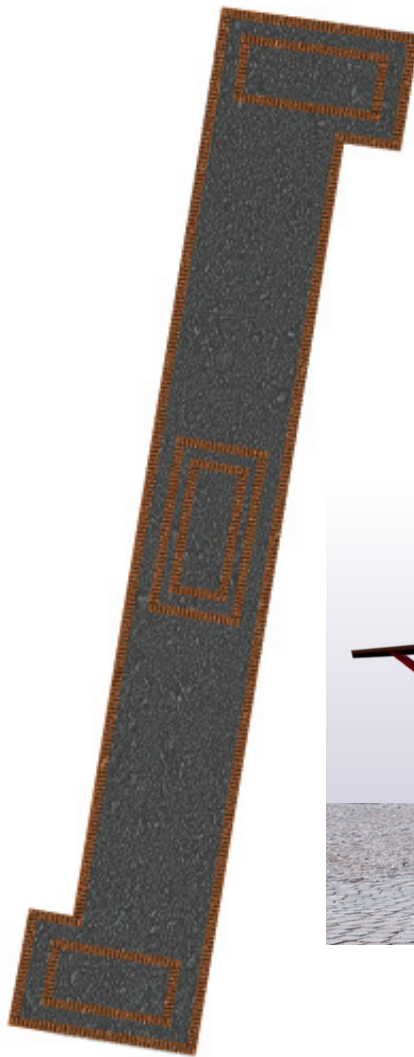
Figur 14. Planutsnitt på brons golv. Golvets kan utgöras av svart asfalt med inslag av tegel.
