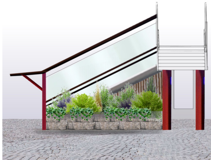
Figur 15. Upp till första vilplanet föreslås trappan kläs in med träribbor, omgärdade med upphöjda planteringar med kanter av återbrukade granitblock från platsen. Detta förankrar bron på platsen och skapar ett fint blickfång vid ankomst till stationsområdet.
