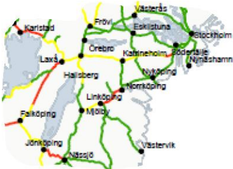
Bild 1: Kapacitetsutnyttjande dygn 2018. Rött = högt kapacitetsutnyttjande, Gul = medelhögt kapacitetsutnyttjande, Grön = lågt kapacitetsutnyttjande
