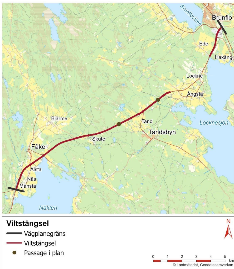
Figur 27 Översiktskarta som visar vilka sträckor som förses med viltstängsel. För detaljutformning se plankartor 104T0201- 104T0218.
