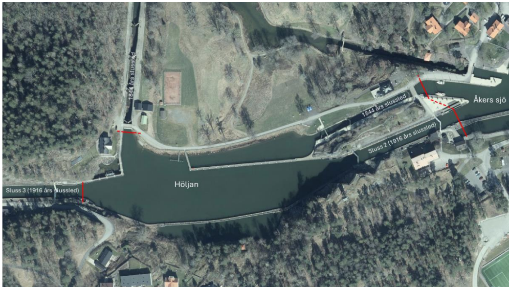
Figur 50. Nya dämmande konstruktioner (röda linjer) för 1916 års slussled och 1844 års slussled i Höljan och i Åkers sjö.
