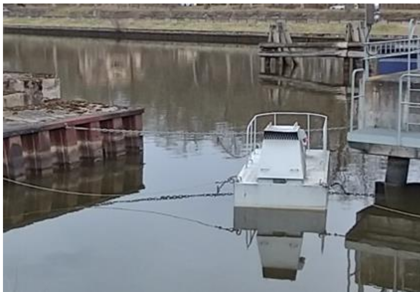
Figur 30. Strömbildare, ljusgrå, förtöjd vid ledverk uppströms slussen i Vänersborg.
