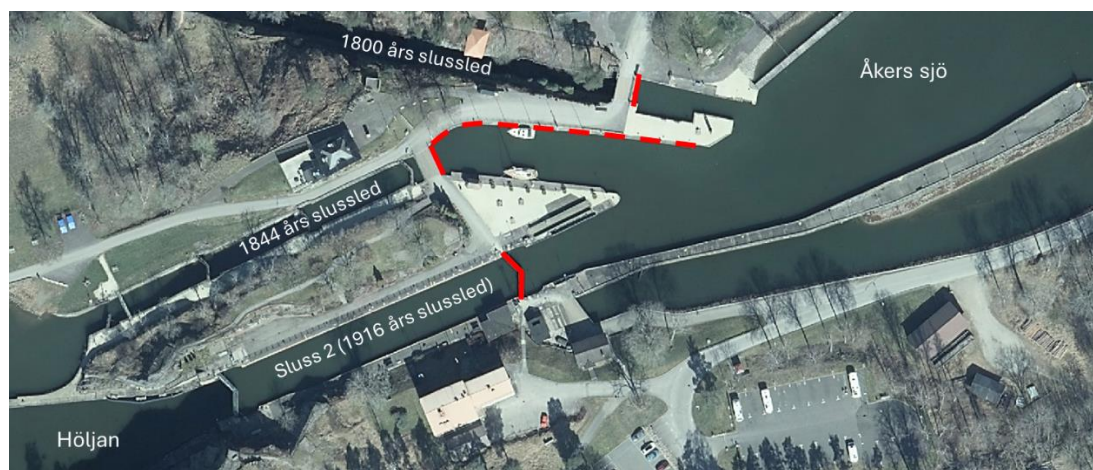
Figur 20. Översiktsbild över området uppströms slusslederna i Åkers sjö. Dämnande konstruktioner markerade med rött. Sidomur och parti över berg markerade med streckad linje.
