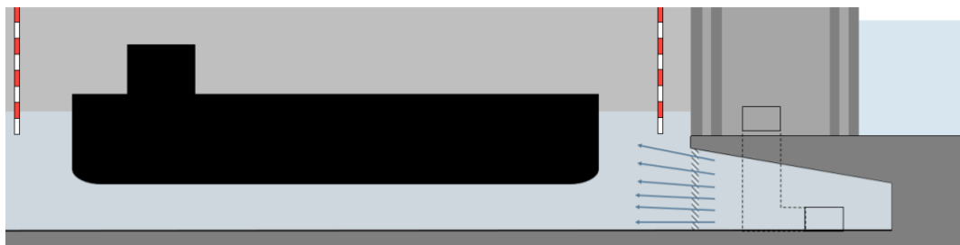
Figur 49. Fyll- och tömsystem som stilling chamber.
