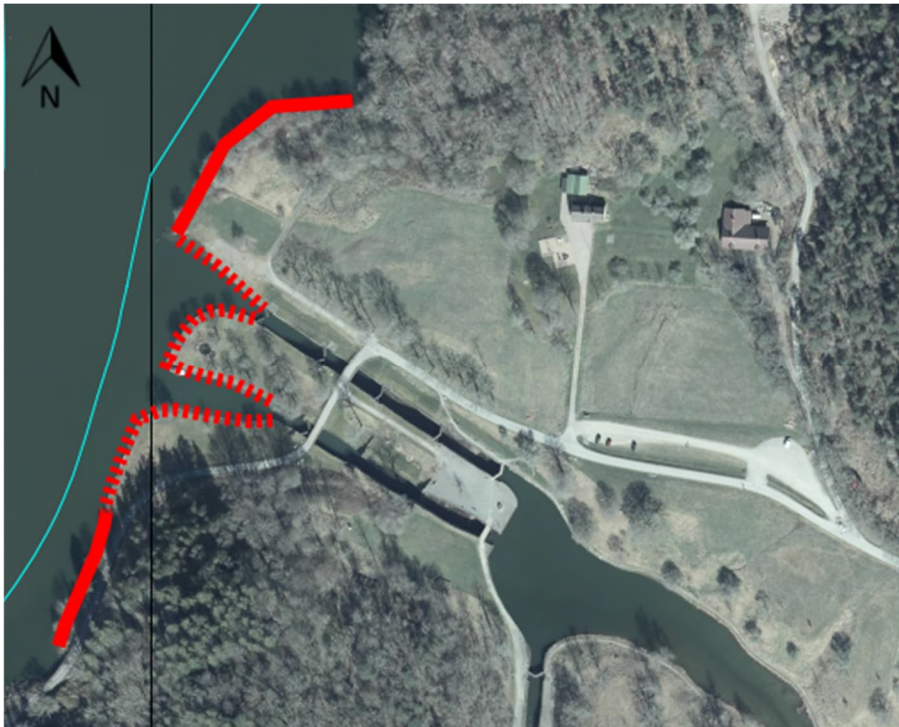
Figur 27. Befintliga erosionsskydd och kajmurar vid Åkers vass. Röd heldragen linje visar befintliga erosionsskydd. Röd streckad linje visar befintliga kajmurar.
