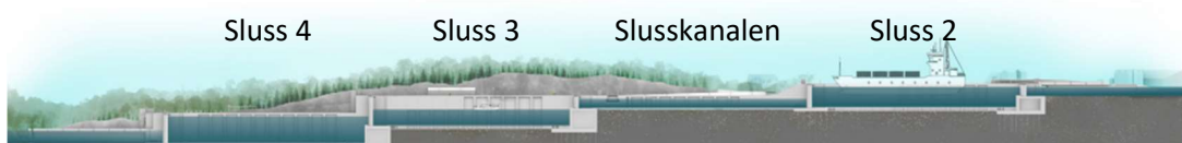
Figur 5: Slussleden i längsgående skärning. Till vänster visas den västra slussen (Sluss 4) med slushuvud mot Göta älv. Den högra sidan visar den östra slussen (Sluss 2) mot Olidans gård och Bergkanalen. Se figur 15 i miljökonsekvensbeskrivningen.
