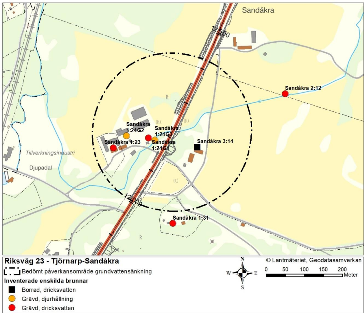
Figur 42. Bedömt påverkansområde grundvattensänkning rörbro km 12/210
