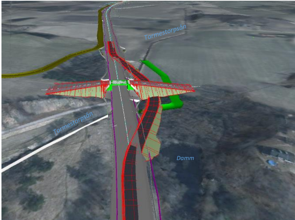
Figur 34. Vy från 3D-modell för projektering norrut över broläget för viltpassage och föreslagen omgrävning av ån i grönt. I bilden framgår ett exempel på placering av tillfällig omledningsväg öster om bron.
