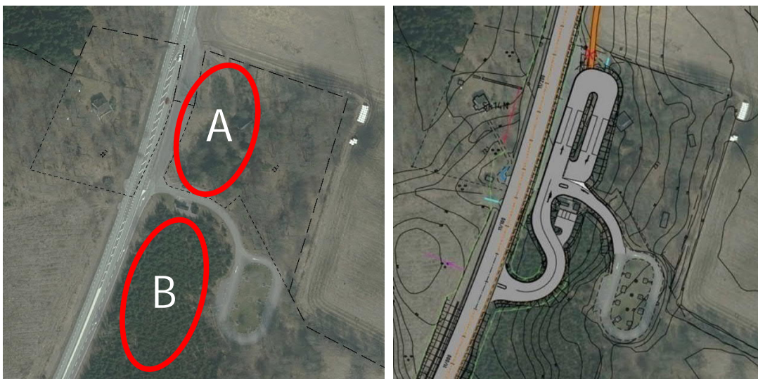
Figur 10. Analyserade alternativ, A och B, för rastplats Norra Mellby till vänster samt föreslagen utformning till höger.
