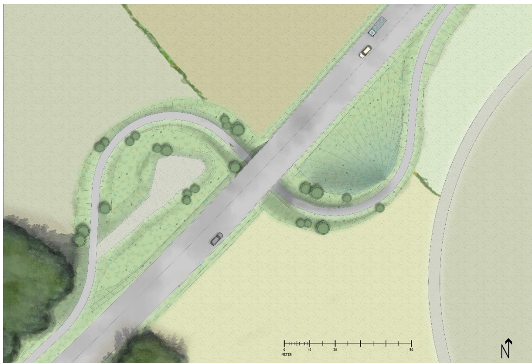
Figur 21. Föreslagen utformning av gång- och cykelpassagen under väg 23 söder om Norra Mellby.
