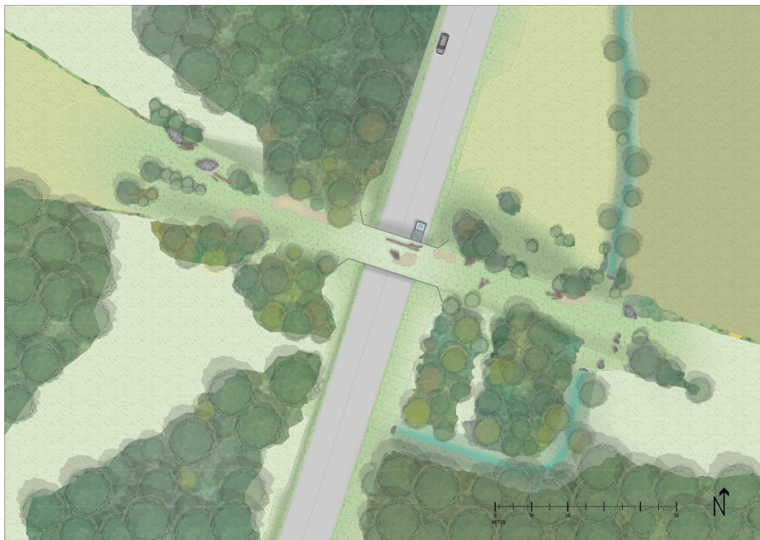
Figur 24. Exempel på utförande av faunapassage.
