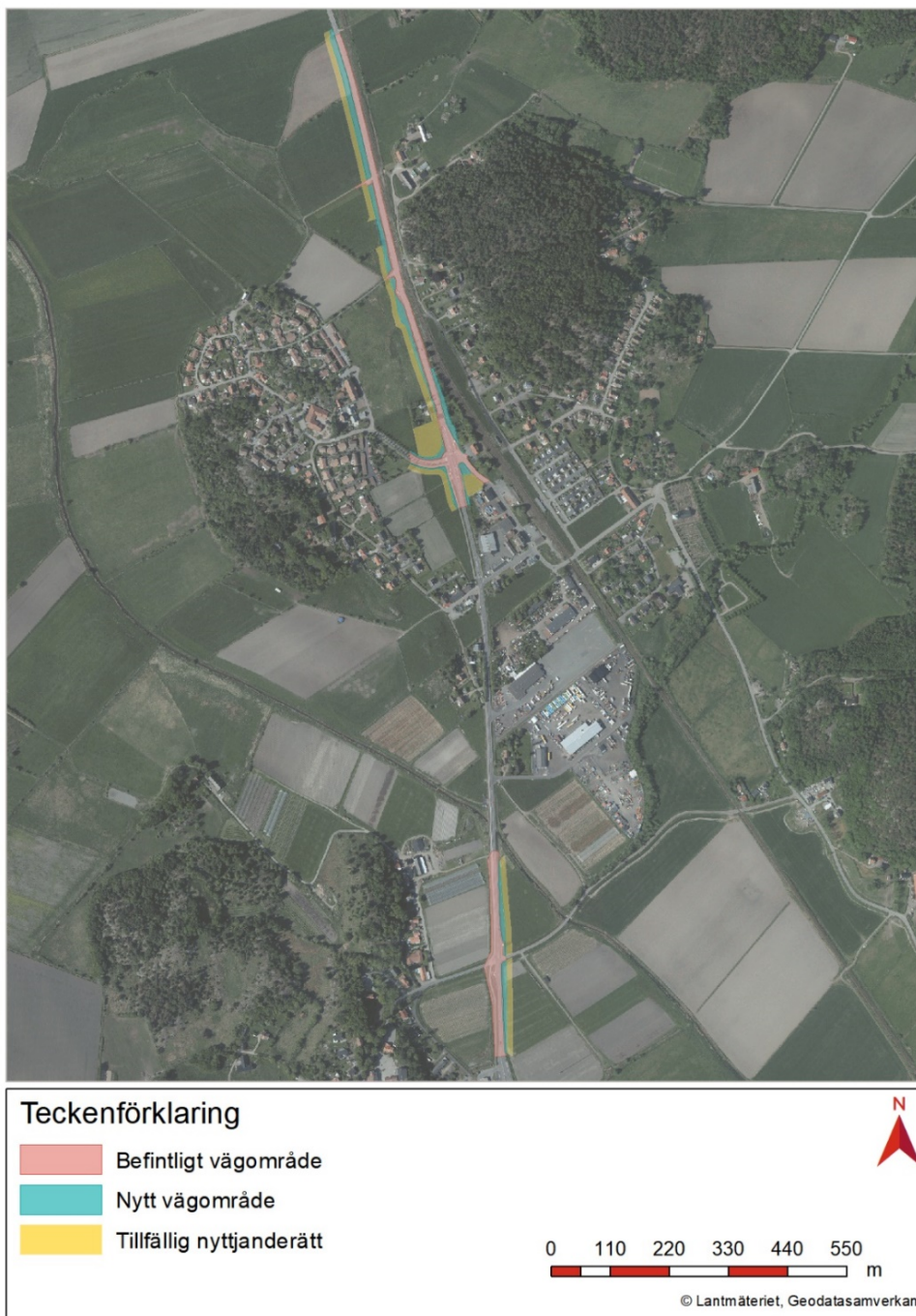
Figur 24. Karta som visar befintligt och nytt vägområde samt tillfällig nyttjanderätt. Utformningen är ett förslag och kan komma att förändras i fortsatt arbete.
