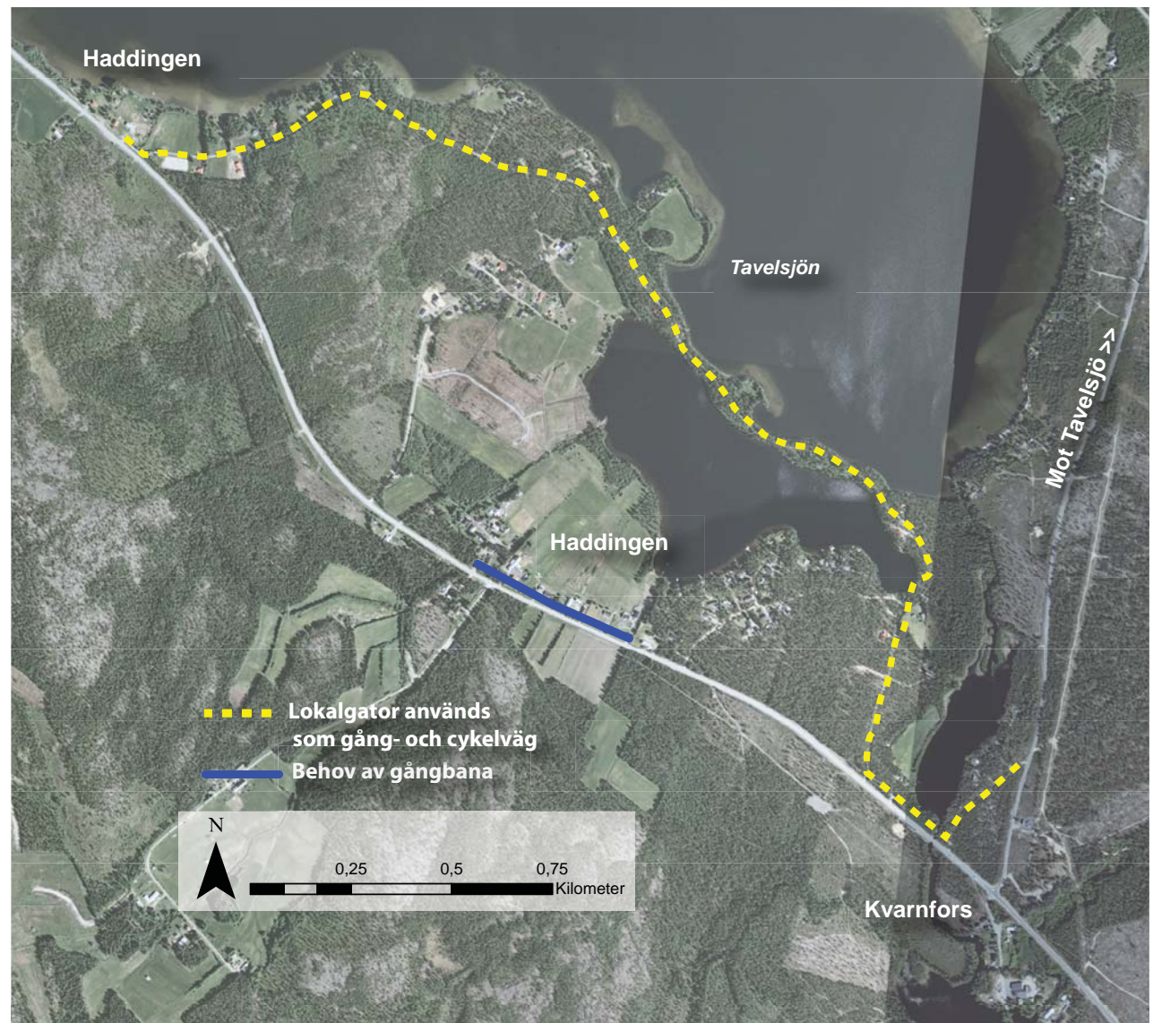
4.3-14 Befintliga lokalgator och cykelvägar, samt tänkbara åtgärder.
