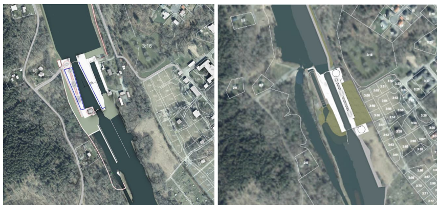
Figur 4. Illustrationerna visar en triangulär sluss i alternativ Väst (bild till vänster), samt en rak sluss i alternativ Öst (bild till höger).
