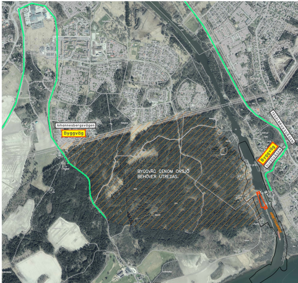
Figur 18. Illustration som schematiskt visar byggvägar om en ny sluss anläggs på västra sidan av befintlig sluss. En ny byggväg behöver anläggas till kanalens västra sida. Vägens sträckning behöver utredas vidare och markeras därför som ett område. Även befintligt vägnät påverkas (ljusgröna linjer).
