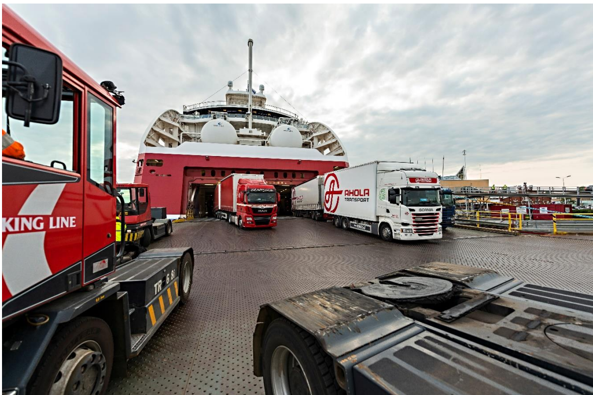
De övre bilderna visar hur trailers lastas ombord med hamntruck (Tug master) för att få in maximalt antal. Den nedre bilden visar hur lastbilar lämnar Viking Grace genom porten i aktern. På däckets ovan lastbilarna syns fartygets bränsletankar för LNG. Foto: © Viking Line
