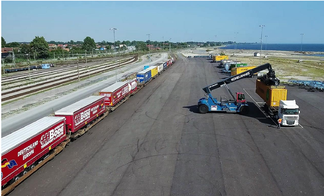
Hamnens kombiterminal där inkommande och avgående tåg lastas och lossas med en Reachstacker. Foto ©Trelleborgs hamn
