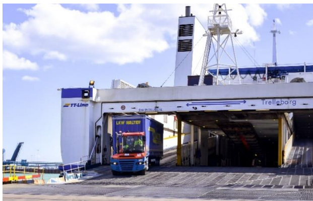
Lossning av färja med en hamntruck som drar en semitrailer. Foto ©Trelleborgs hamn.
