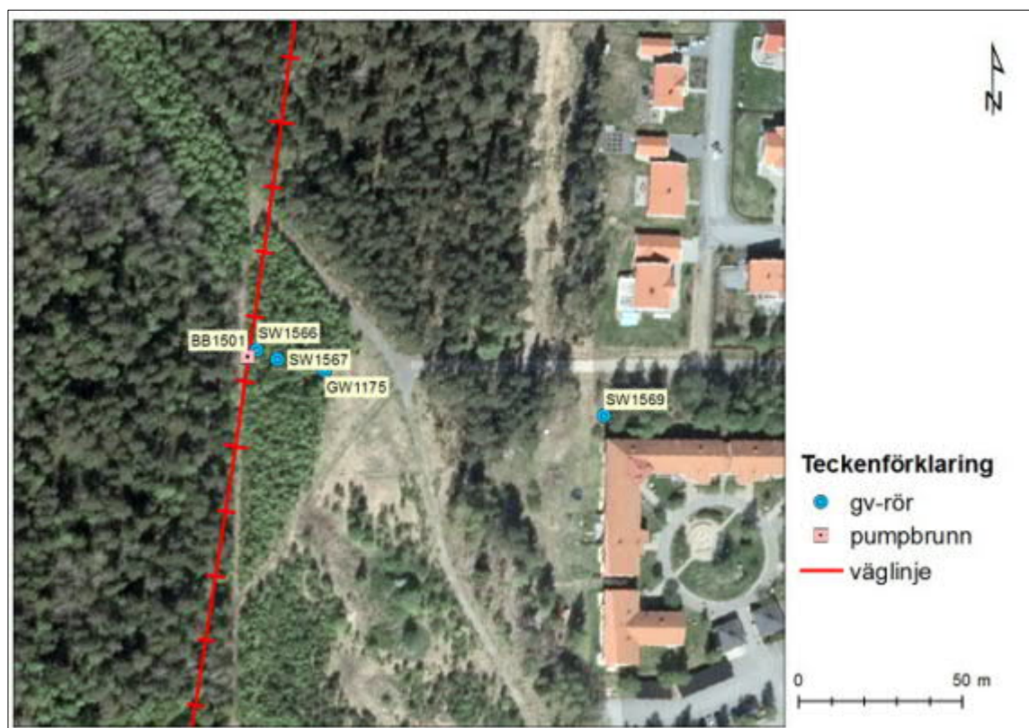
Figur 3. Pumpbrunn och grundvattenrör som användes under provpumpningen vid bro 742.
