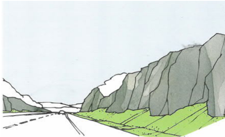
Figur 39. Förebild på bergsskärning där man följt naturliga slag i berget.
