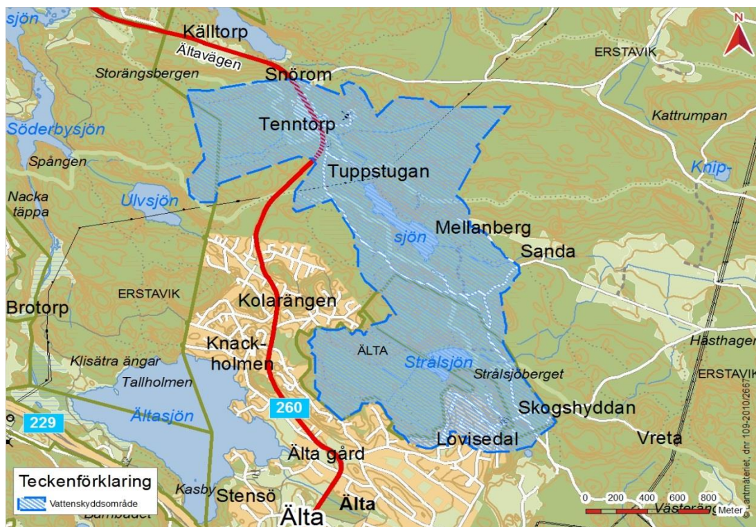
Bild 27. Vattenskyddsområde för Sandasjöns reservvattentäkt överlappar väg 260 vid Tenntorp.
