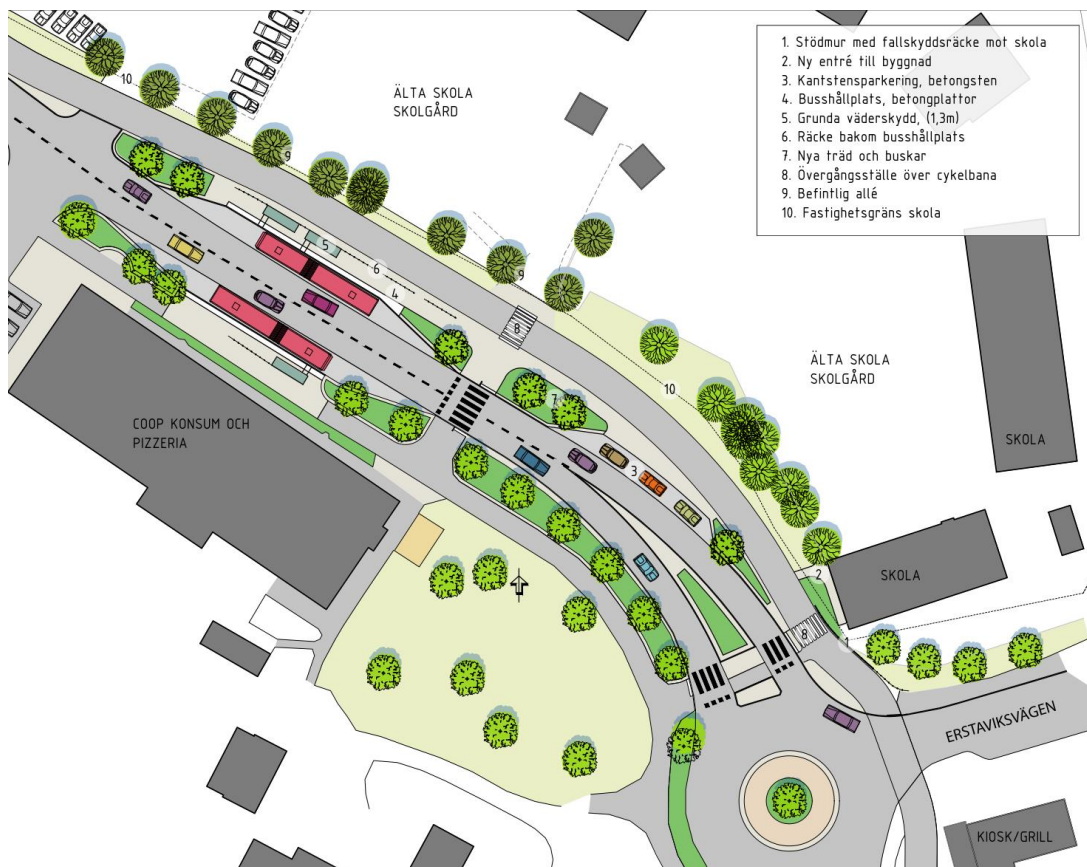
Bild 32. Ombyggnationer vid Älta skola.
