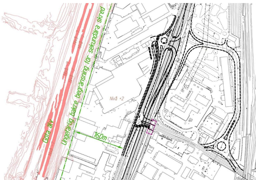
Figur 6. Ungefärlig bakre begränsningslinje vid uppkomsten av sekundära skred
