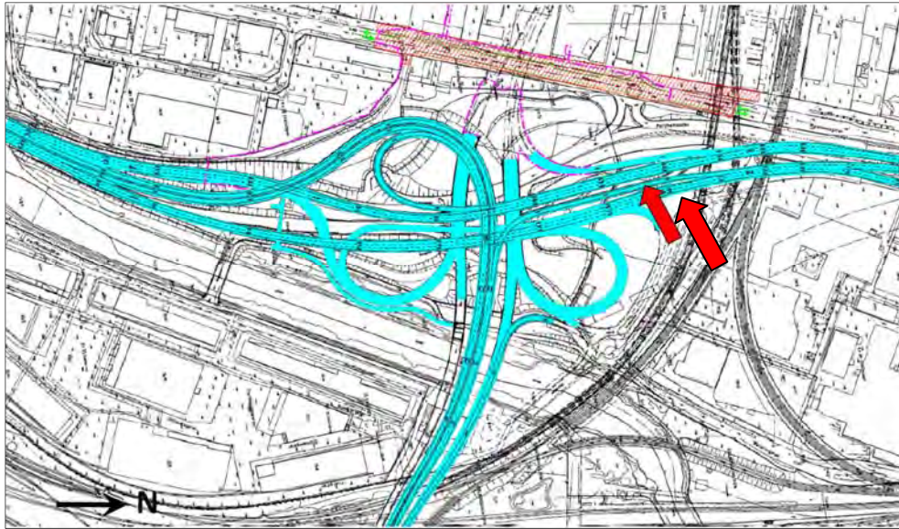
Figur 4:2 Påfartsramp från E20, EFTER utbyggnad av Marieholmsförbindelsen (Trafikverket)
